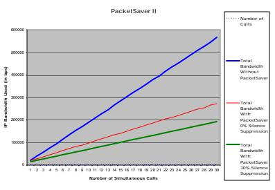
FIGURE II-16 PACKETSAVER BANDWIDTH COMPARISON
