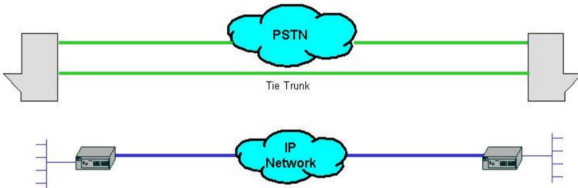
FIGURE II-19 TYPICAL TIE-TRUNK
